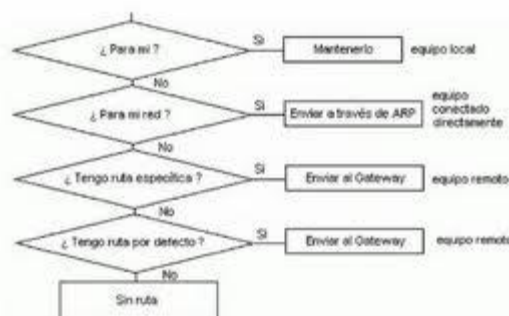
Figura 1. Encaminamiento de paquetes en arquitectura TCP/IP.
